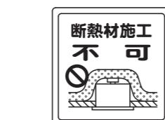
**△警告** 断熱施工天井に取付けない(火災の原因)
