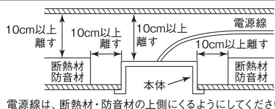
電源線は、断熱材・防音材の上側にくくるようにしてください。
